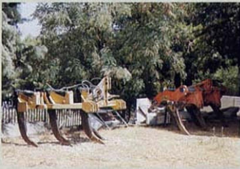
► A volte i Di Lecce effettuano rippature profonde 50 cm e oltre, o con ripper a cinque ancore disposte a V (a sinistra), oppure con ripper a cinque ancore disposte su due file (a destra).
