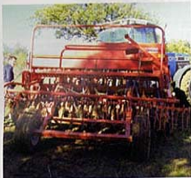
Fig.3. Seminatrice Directa-Gaspardo con particolare degli organi assolcatori
