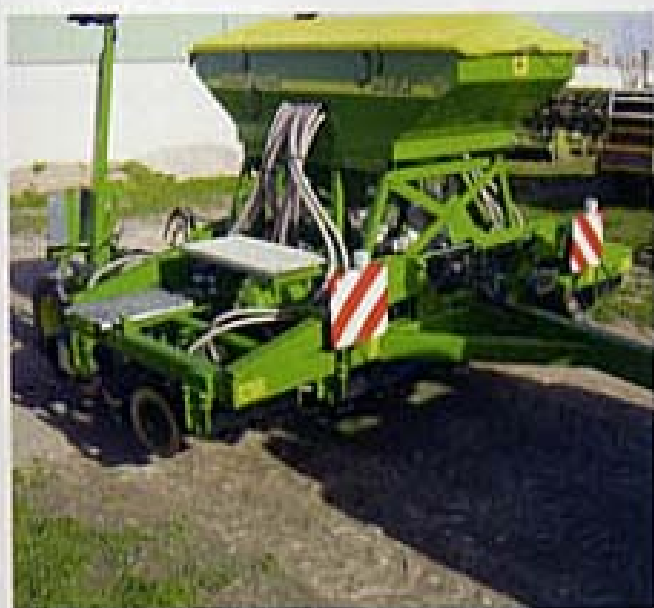
Seminatrice John Deere 750 A con particolare degli organi assollatori
