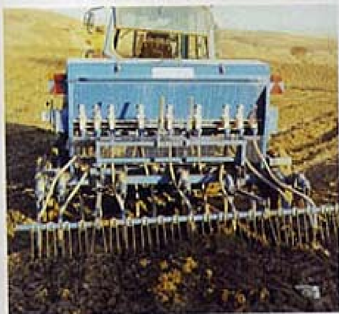
Fig. 2. Seminatrice Laseminasodo con particolare degli organi assiculatori
