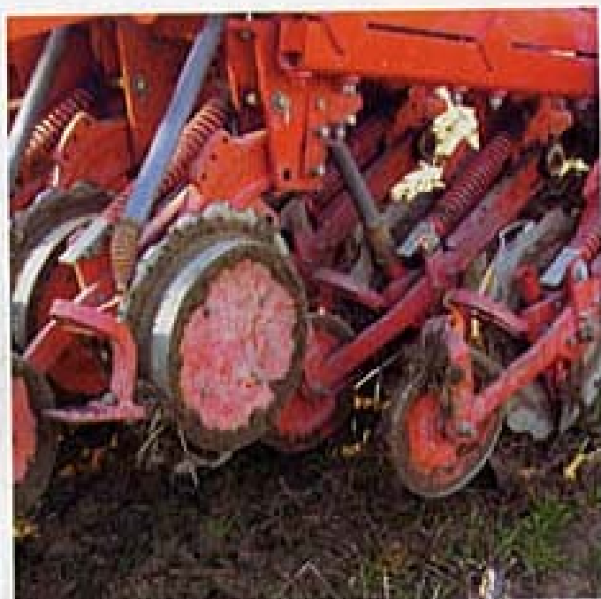
Fig.3. Seminatrice Directa-Gaspardo con particolare degli organi assolcatori
