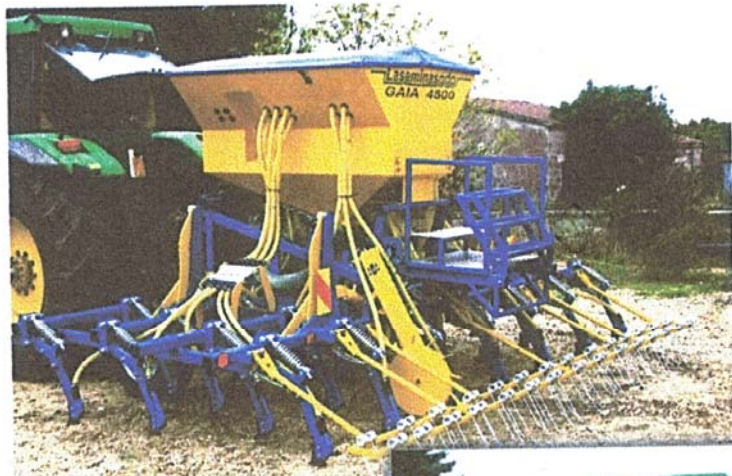
■ Veduta posteriore della seminatrice Gaia, con distanza di semina di 4,5 m.
